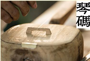
取需要的竹料寬度，以削竹刀裁成三角形，並以削刀挖出凹槽，最後用砂紙打磨修飾，並安裝在琴鼓上。
