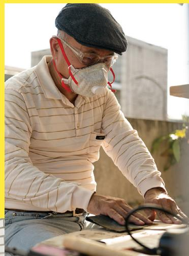
製作過程需戴上護目鏡與專用口罩，以隔絕木工施作所產生的粉塵。
