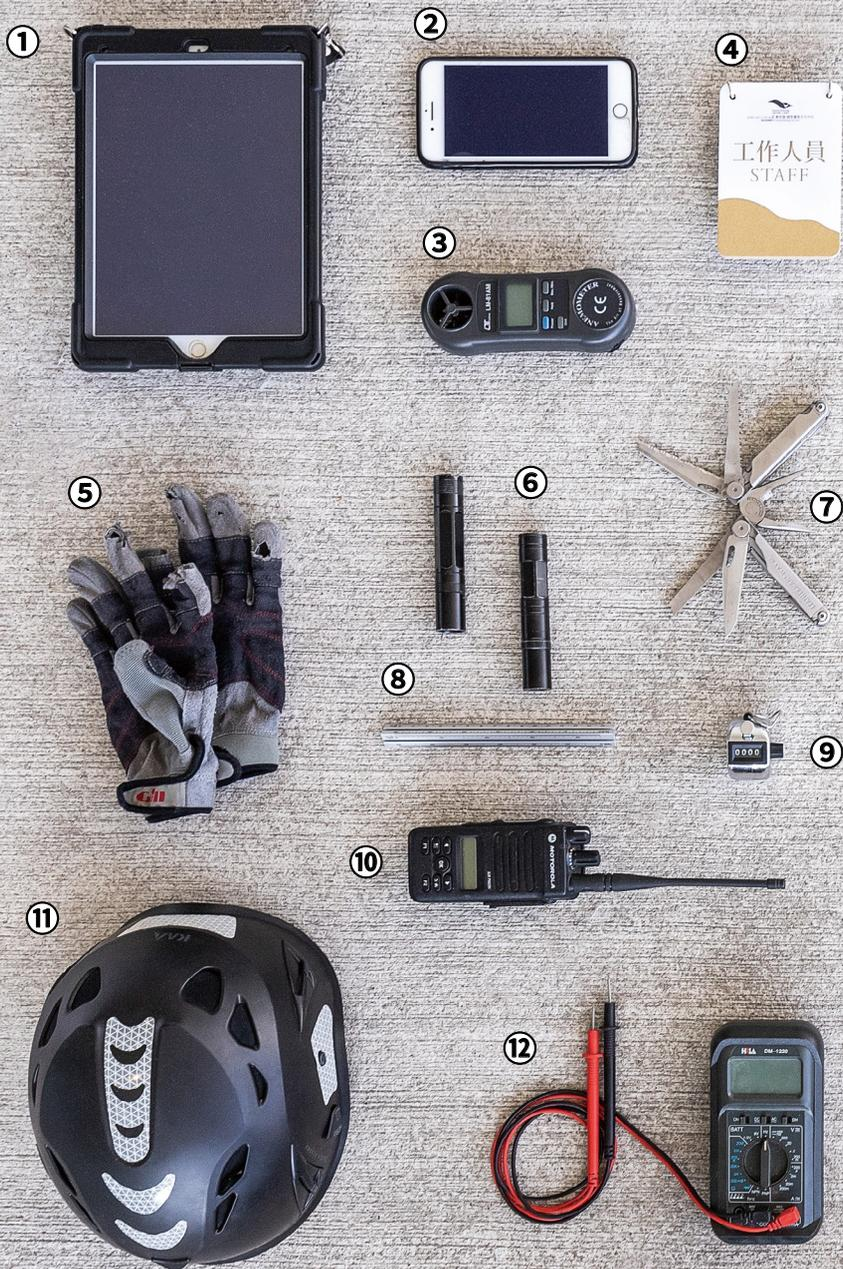
① 平板電腦 劇場也要無紙化。將舞臺圖表存在 pad 裡，就不必隨身帶著一堆圖紙。② 手機 可用來溝通聯繫也可查詢資料。③ 風速表 用在戶外搭臺或施作時了解現場風速，避免風速過大發生意外。④ 工作證 為了識別身分，避免閒雜人等進入工作區域發生危險。不同組別有時會以不同顏色來區分。⑤ 工作手套 用來保護萬能的雙手。⑥ 雷射筆 + 手電筒 工作時，雷射筆可從遠處指出需要調整的地方；手電筒則能在舞臺上燈光不足時，提供額外照明，也有人會用頭燈取代。⑦ 萬用工具鉗 劇場人俗稱怪家私 (Ke-Si，臺語「工具」之意)，是拆卸、修剪物品時必備的工具。⑧ 三角比例尺 用來確認設計圖與現場的尺寸是否符合。共有六面，每一面的比例都不同。⑨ 計次器 確認演出時的進場人次，方便控管。
